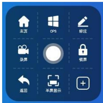
主页按键，点击后回到主页；OPS按键，点击进入OPS通道；批注按键，点击打开批注功能；录屏按键，点击打开录屏功能；锁屏按键，点击打开屏幕锁；返回按键；半屏显示，仅通道下可用；全屏显示，半屏显示状态下点击返回全屏；自定义按键，可在悬浮菜单上自定义应用按键，点击后弹出自定义窗口。
